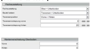
Hier kann der Oberboden als Traverse ausgeführt werden. Gesetzt werden eine Traverse vorne und eine hinten. Wahlweise kann auch nur eine der beiden gesetzt werden. Mit Rücksprung kann die Traverse vorne und hinten eingerückt werden.
