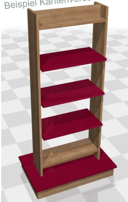
Beim roten Unterboden sind die Kanten nach außen verschoben und beim Korpus im Holzdekor sind die Kanten nach innen verschoben, so dass die Mittelböden vorne und hinten überstehen. Mit der Kantenverschiebung lassen sich viele Lösungen leicht planen
