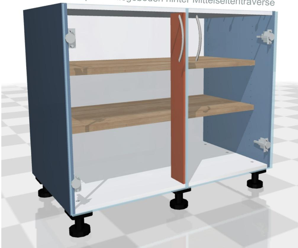
Mit Hilfe der Fachausstattung „Fach in Fach“ wurden in diesem Beispiel eine Mittelseite und Einlegeböden in das selbe Fach eingefügt. Um Dafür zu sorgen das die Bauteile sich nicht Überschneiden, kann man mit Facheinrückung oder mit Kantenverschiebung arbeiten. In diesem Beispiel wurde der Rücksprung der Einlegeböden auf 105mm gesetzt um zu verhindern das die Einlegeböden mit der 100mm tiefen Mittelseite kollidieren.
